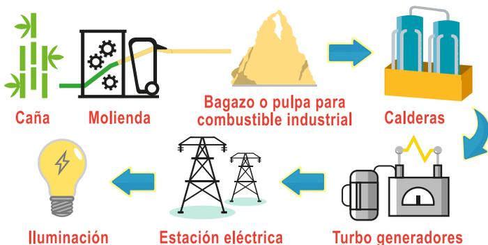
En las calderas se quema el bagazo, ahí se genera vapor de alta presión que se vuelve energía térmica, la cual es conducida a turbogeneradores para producir energía eléctrica.
